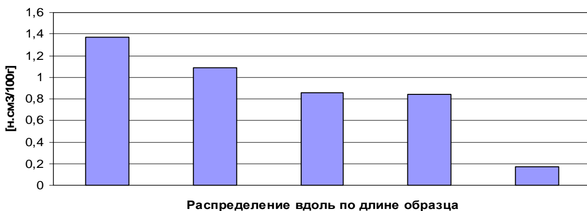
Рис. 2. Распределение диффузно-подвижного водорода. Слева – точка разрушения, справа – выточенный из недеформированного участка пробы образец. (Диаграмма построена в технических единицах содержания водорода 1 \text{ [н.см}^3/100\text{г]} = 0,89 \text{ [млн}^{-1}\text{]} )
