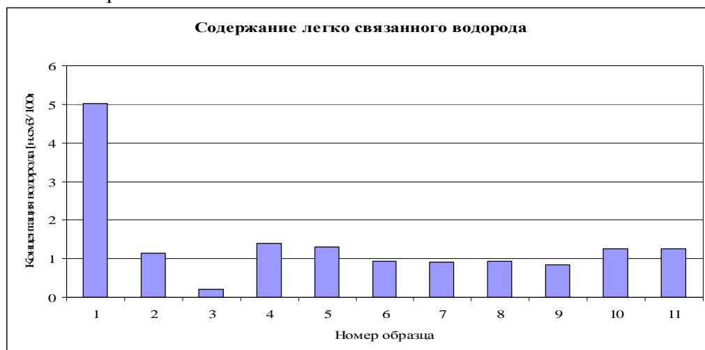
Рис.6. Распределение диффузно-подвижного водорода. Слева – точка разрушения, справа – образцы, врезанные из недеформированного участка пробы образцы
